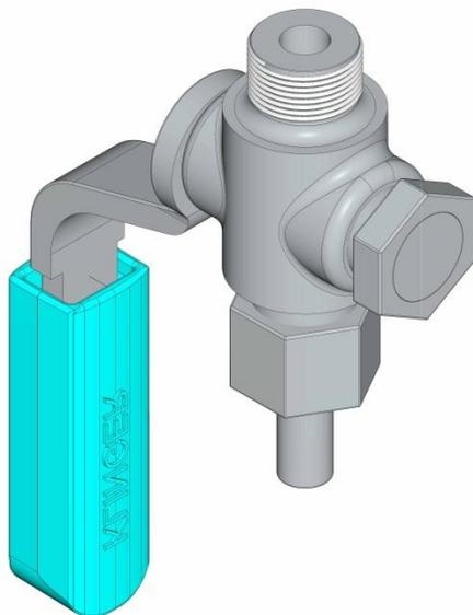
Klinger ABL: rubinetto di scarico rapido, del tipo maschio cilindrico rettificato a tenuta morbida mediante un bossolo elastico interposto tra il corpo del rubinetto ed il maschio.
