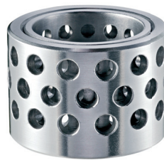
Lanterna Baixo Ruído e Anti-cavitação: este sistema evita que ocorram ruídos maiores que os especificados por norma nas aplicações com gases ou cavitação nas aplicações com líquidos, garantindo perfeito controle do fluido e evitando desgaste interno.
