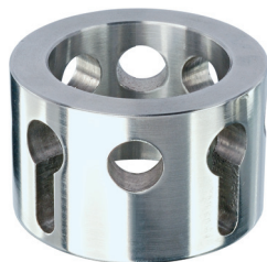
Lanterna Igual Porcentagem: garante que seja mantida uma relação porcentual constante entre a variação de vazão (+/-) e a vazão anterior.
